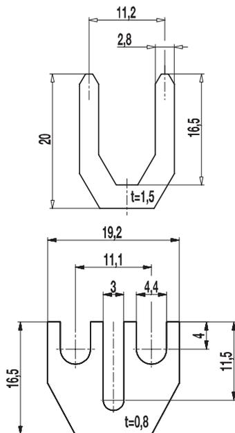
Die Brücke 307-V ist speziell für die Verbindingleisten der Serien 307-PCF und 3070-PCM konzipiert. Sie verbindet 2 benachbarte Pole mit beliebigem Aufbau durch Einschlagen von oben in die Rohmieten, wodurch ein einwandfreier elektrischer Kontakt erzielt wird. Diese Brücke ist nicht in Verbindung mit den Abdeckkappen verwendbar.
