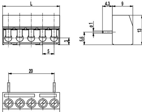
Die Leiterplattenklemme 971-X.. im „Raster“ 5 mm mit 2 bis 12 Schraubanschlüssen bei einem Pol, kann z.B. als Potentialverteiler verwendet werden. Damit lassen sich Erdleiter auf einfache Weise durchschleifen.
